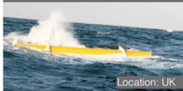
A.P.- Oyster 800: 800kW prototype, UK
