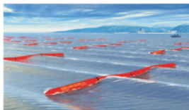
Pelamis- P2: 750kW prototype, UK
